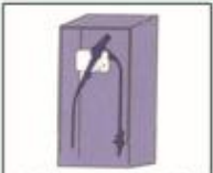
آندوسکوپ‌ها را به طور عمودی در یک فضای دارای لوله‌های ایزولان کنید. قسمت‌های جداشدنی را در تنها در زمانی استفاده از دستگاه، در روی آن نصب کنید.
